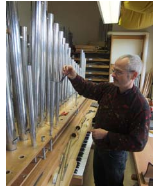
Gregor Hieke, Chefintonator bei Eule in Bautzen, gibt den Pfeifen ihren individuellen Klang. Fotos: Eule (5)
