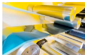
Verkapselung organischer Solarfolien. Foto: Heliatek
